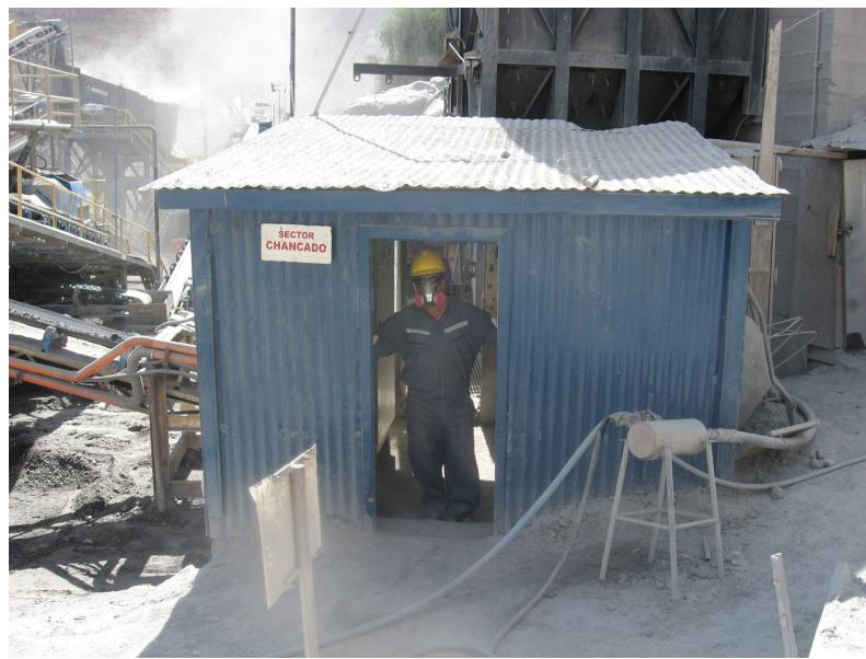
2. Fabricación de caseta para proteger unidad de lubricación chancador secundario planta de chancado 1 y facilitar maniobras de operadores y mantenedores en accesos
